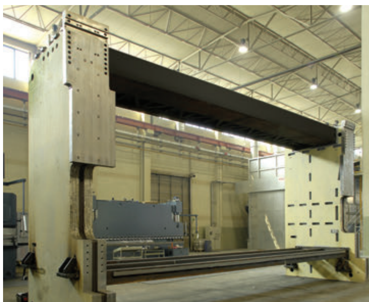
Жесткая коробчатая конструкция
