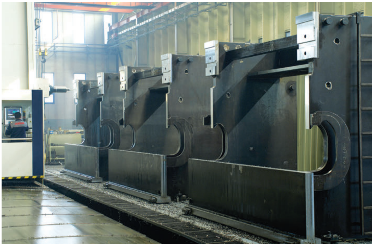
Механическая обработка рамы листогибочных прессов тандем, трио и тетра
