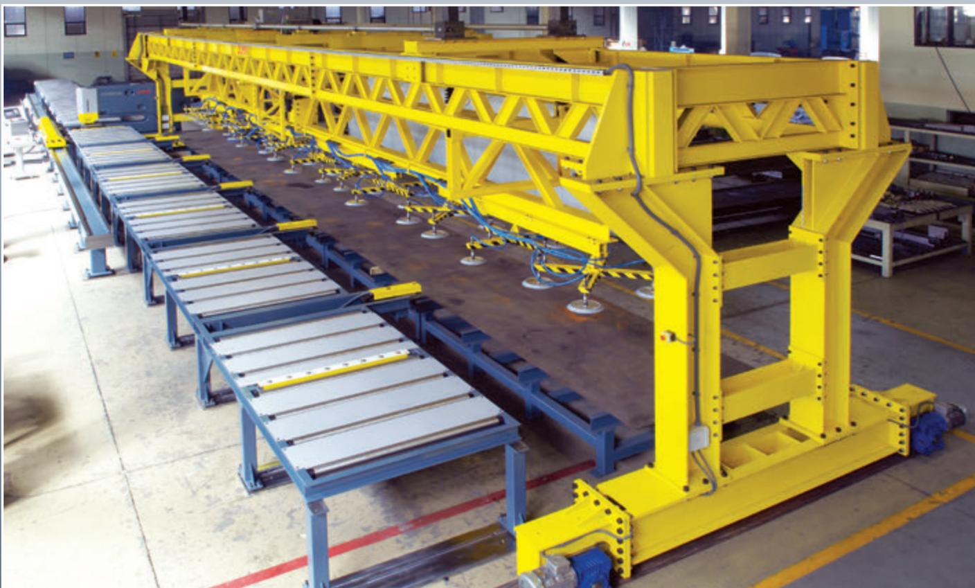
Автоматическая линия пробивки длинных листов с загрузкой и разгрузкой
